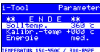
Die Solltemperatur ist die zur Bearbeitung voreingestellte Werkzeugtemperatur des aktiven Lötwerkzeugs.
