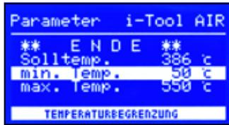
Die Parameter Min. Temp. und Max. Temp. bestimmen den Temperaturbereich, in dem die Werkzeugtemperatur einstellbar ist.
