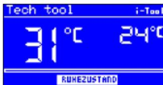
Die einstellbare Shutdown-Funktion (Ruhezustand) dient der Energieeinsparung und der Verlängerung der Lebensdauer von Lötspitzen und Heizkörper. Im Ruhezustand kühlen die Werkzeuge bis auf Raumtemperatur ab. In der unteren Displayzeile wird dann der Text [Ruhezustand] angezeigt. Sie können den Ruhezustand jederzeit beenden, indem Sie den i-OP betätigen.
