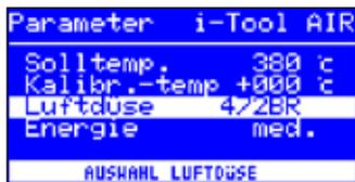
Die Luftmenge und Temperatur des i-TOOL AIR S kann an die verwendete Heißluftdüse und den Lötprozess angepasst werden. Ist das i-TOOL AIR S an die Station angeschlossen, so erscheint die Option [Luftdüse]. Nach Drücken des i-OP kann hier der Typ der verwendeten Heißluftdüse eingestellt werden. Nochmaliges Drücken bestätigt die Auswahl.
