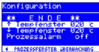
Für jede Werkzeugbuchse kann ein eigenes Temperaturfenster mit einem separaten oberen und unteren Bereich definiert werden. Wenn sich die Ist-Temperatur in diesem Fenster befindet, wird im Arbeitsmodus ein „OK“ angezeigt.
