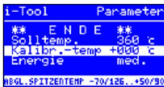
Diese Funktion dient zur Kalibrierung der Lötspitzentemperatur. Sie ermöglicht das Abgleichen von Anzeigewert und tatsächlicher Spitzentemperatur. Der einstellbare Kalibrierbereich beträgt -70...+50 °C / -126...+90 °F.
