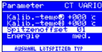
Durch die unterschiedlichen Massen und geometrischen Formen der Lötspitzen (Tip) ist deren Temperaturverhalten unterschiedlich. Der Spitzenoffset dient dazu, die Temperaturmessung an die jeweils verwendete Lötspitze anzupassen. Die Einstellung der verwendeten Lötspitze erfolgt in Form einer Nummer.
