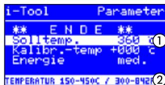
Der Parametermodus wird nun für das ausgewählte Werkzeug aktiviert. Durch Drehen am i-OP wird der gewünschte Parameter ausgewählt. Zum selektierten Parameter ① wird in der letzten Zeile ein Hilfetext ② eingeblendet, der zusätzliche Erläuterungen oder Zahlenbereiche darstellt.
